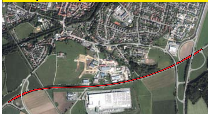
Der Verkehr auf der B 31 aus Richtung Tuttlingen in Fahrtrichtung Freiburg wird während der Baumaßnahme durch den Baustellenbereich geführt. Der Verkehr aus Richtung Freiburg wird an der Anschlussstelle Hüfingen-West von der B 31 ausgeleitet und durch die Ortsdurchfahrt Hüfingen geleitet.
